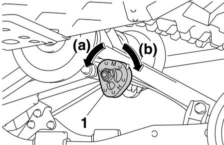
1. Регулятор предварительного натяжения пружин
