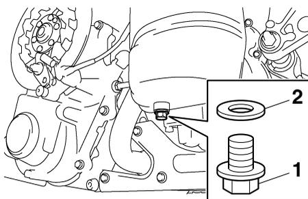
1. Болт слива моторного масла (из масляного бака)
