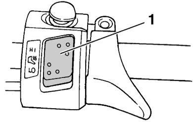
1. Регулятор обогрева рычага управления дроссельной заслонкой
