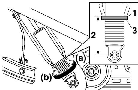
1. Регулировочная гайка предварительного натяга пружины
