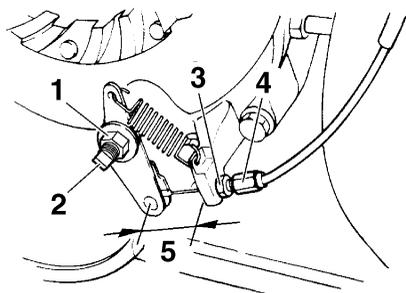
1. Контргайка регулировочного болта колодки стояночного тормоза
