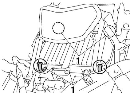
1. Крепление крышки корпуса воздушного фильтра
