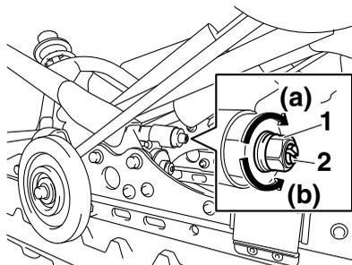
1. Регулировочный болт демпфирующей силы сжатия (для быстрого демпфирования сжатия)
