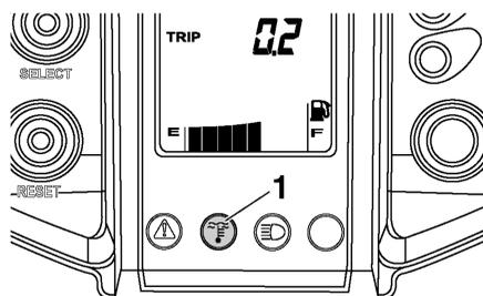
1. Индикаторная лампа низкой температуры охлаждающей жидкости “
