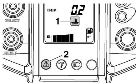
1. Предупреждающий индикатор перегрева охлаждающей жидкости “”
