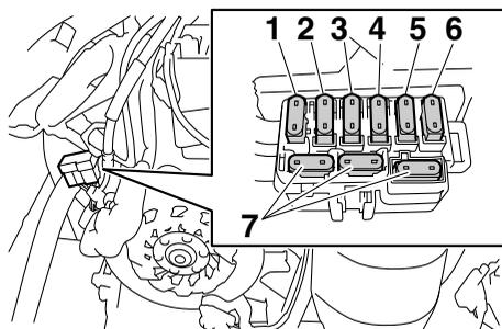
1. Предохранитель цепи зажигания "IGN"
