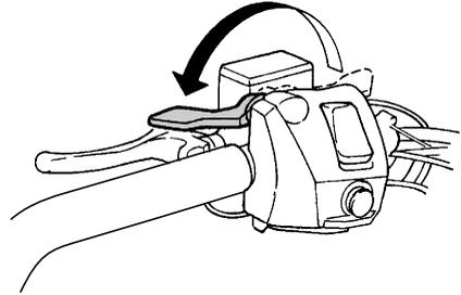
2. Убедитесь, что выключатель двигателя находится в рабочем положении. При выключенном выключателе двигателя стартер не работает.
