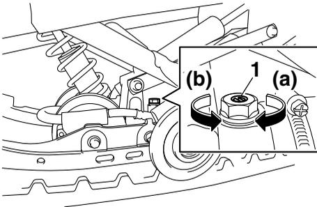
1. Регулировочный винт демфирующей силы сжатия
