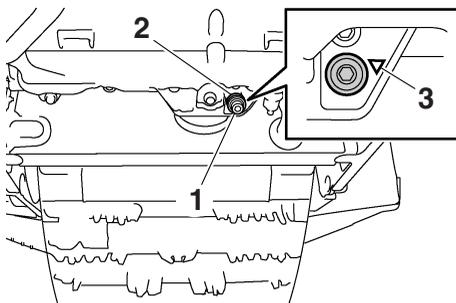
1. Болт слива моторного масла (из картера)
