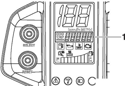
1. Счетчик пробега/счетчик пройденного пути/счетчик частоты вращения двигателя
