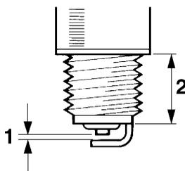
1. Искровой зазор свечи зажигания
