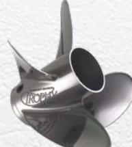
Четырехлопастной гребной винт из нержавеющей стали с шагом винта от 12" до 23". Обеспечивает подъем носа, плавность хода и выход на глиссирование. Идеально подходит для катания на водных лыжах и вейкборде. Подходит для подвесных двигателей мощностью от 75 л. с. и выше.
