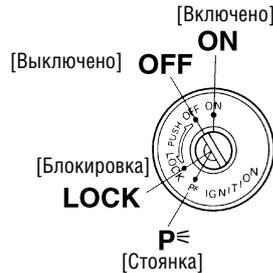
Замок зажигания / блокировки руля управляет системой зажигания и приборами освещения, а также используется для блокировки руля. Действие ключа в различных положениях поясняется ниже.
