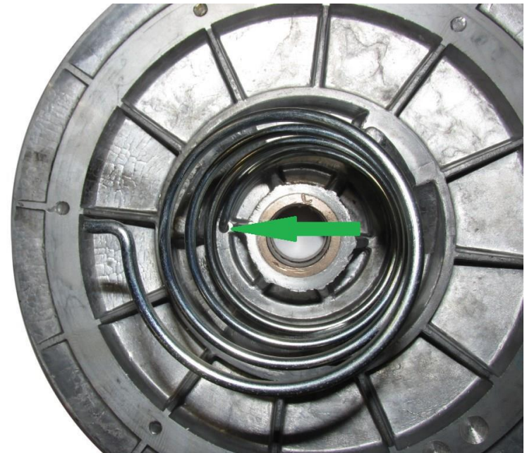
6. Вставляем нижний конец пружины в отверстие в подвижном шкиве (отмечено зелёной стрелкой) так, как указано на рисунке.
