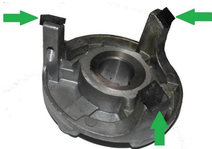
3. Правильно установленные вкладыши на полумуфте выглядят так, как указано на рисунке.
