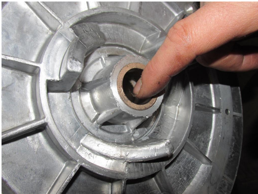
5. В подвижный шкив закладывается тонкий слой смазки (Литол-24 или аналоги).
