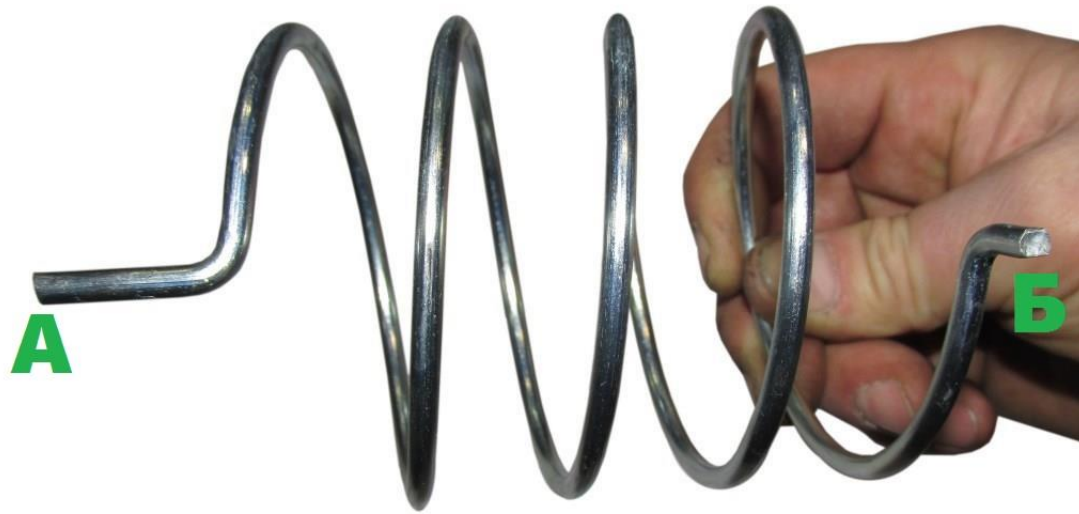
4. Положение концов пружины в спокойном состоянии: А – нижний конец пружины; Б – верхний конец пружины.
