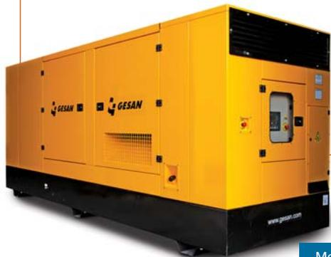
В-117-57. Это гарантирует 15-летнюю эксплуатацию кожуха на промышленных площадях при повышенной влажности и агрессивности среды, а также эксплуатацию вне помещения на строительных площадках в условиях конденсации влаги и повышенном уровне загрязнений. В качестве шумоизолирующего материала используется слой огнестойкого масло- и водонепроницаемого стекловолокна, расположенный на внутренних поверхностях кожуха.
